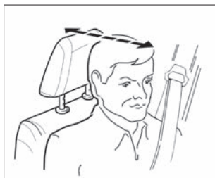
Рис. 11б. Оптимальное положение подголовника
