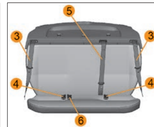
Рис. 13б. Ремни безопасности заднего сиденья
