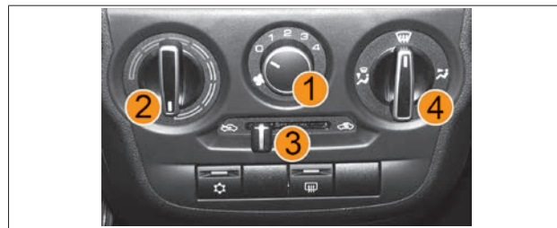
Рис. 37. Блок управления системой вентиляции и отопления
