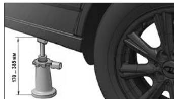
Рис. 3. Положение домкрата при замене колеса
