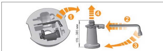
Рис. 5. Положение инструмента в органайзере (вариантное исполнение) и последовательность работы с домкратом
