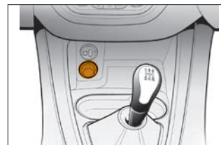
Рис. 1а. Розетка для подключения дополнительного электрооборудования
