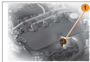
Рис. 4. Проверка уровня масла в картере двигателя
