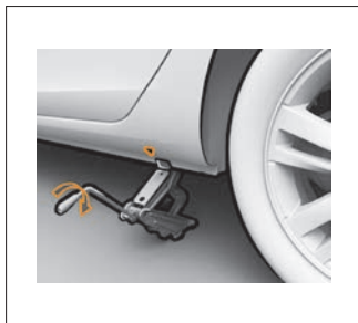
Рис. 3. Положение домкрата при замене колеса
