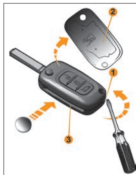
Рис. 10. Замена элемента питания пульта дистанционного управления
