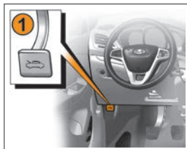
Рис. 1. Рукоятка для открытия капота
